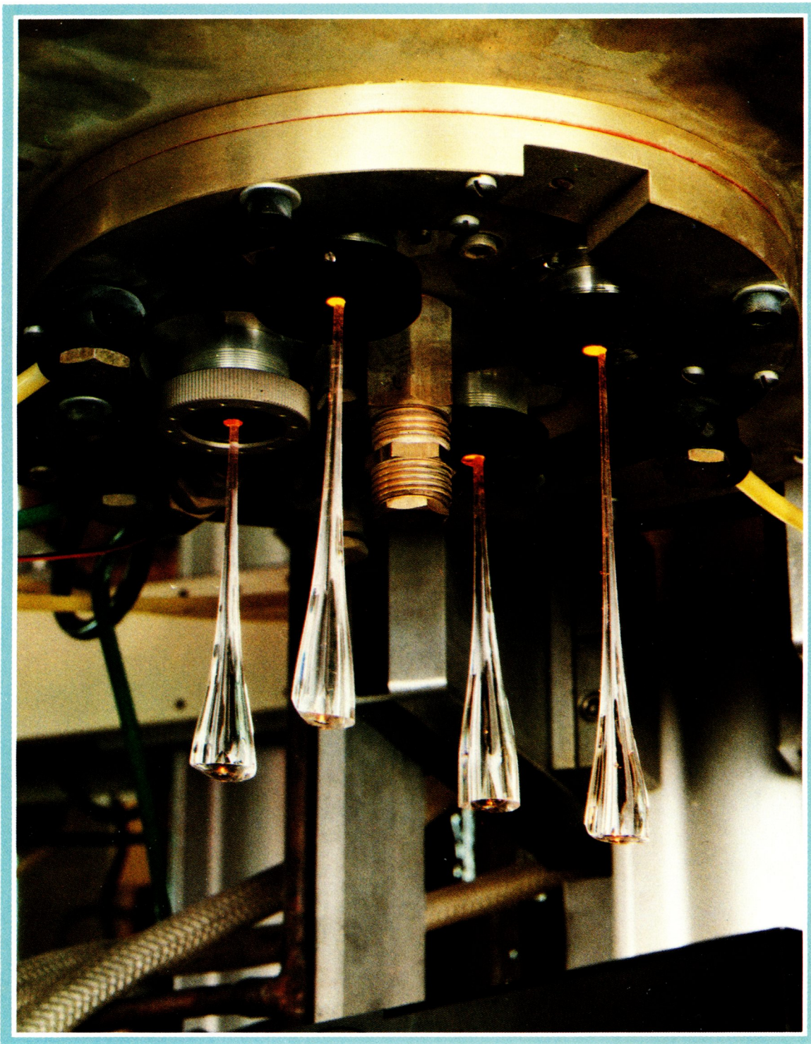
Fabrication de fibres optiques.
