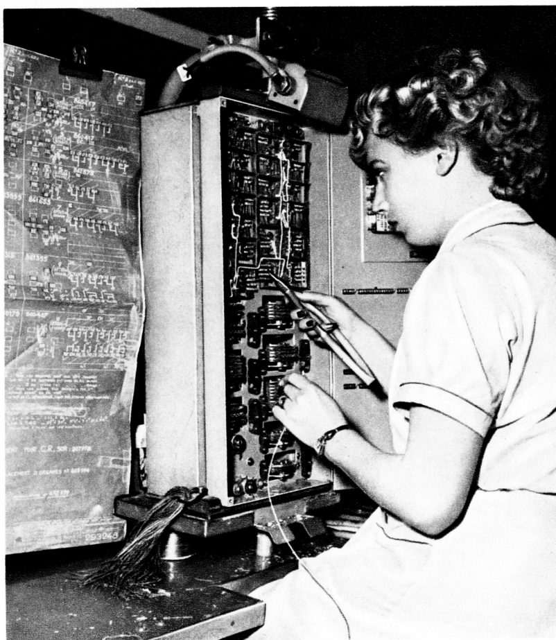
Câblage et soudage d'un enregistreur.→
