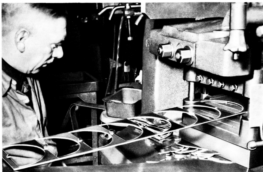
↑ Découpage des flasques de commutateurs rotatifs.
