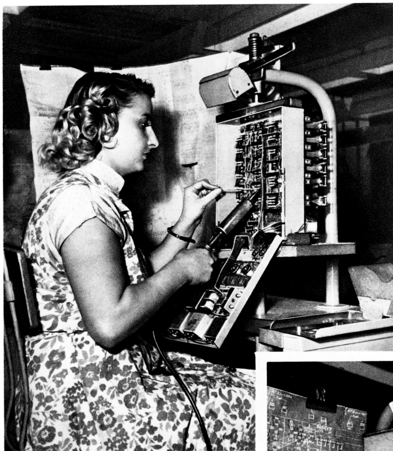
← Câblage et soudage d'un groupe de relais.
