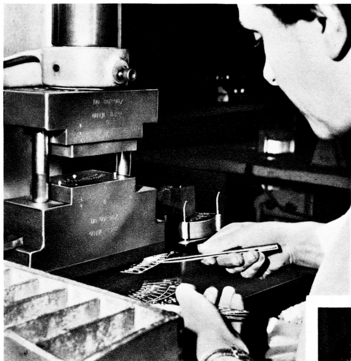
← Découpage des bancs de commutateurs rotatifs.
