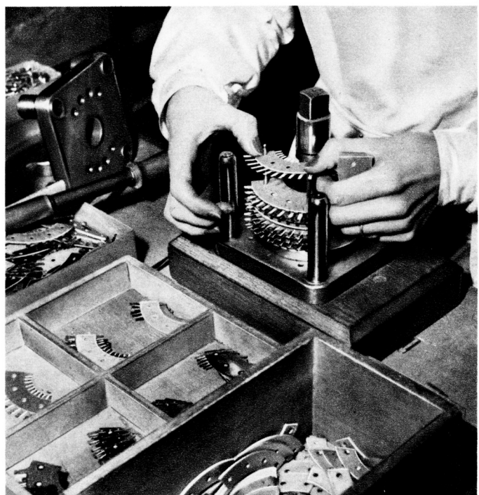
← Montage des bancs de commutateurs rotatifs.
