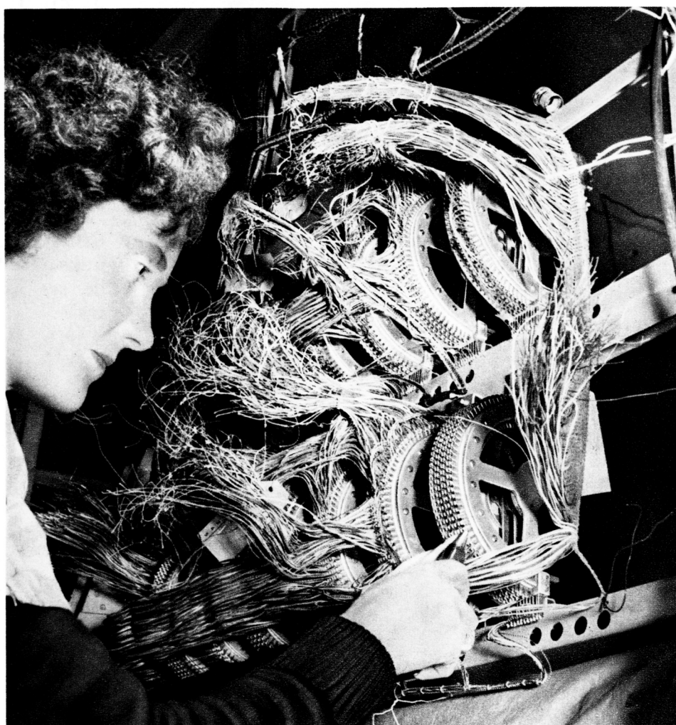
Raccordement des fils de multiplage sur rangées. →
