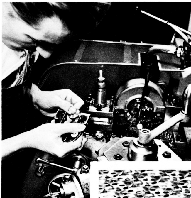
↑ Usinage des roues à rochet des commuta- teurs rotatifs.
