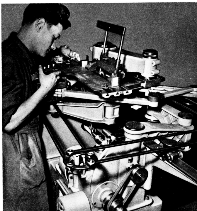
Machine de précision à rectifier les matrices. →
