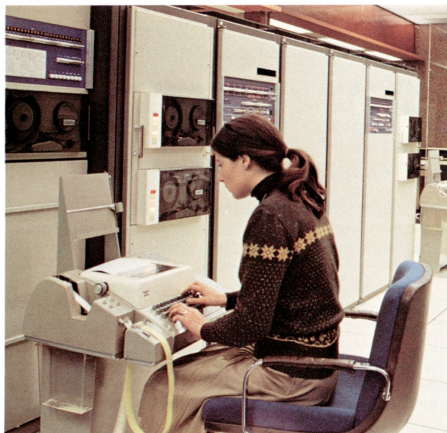
Fig. 31 - Dialogue avec les calculateurs par l'intermédiaire d'un téléimprimeur.
