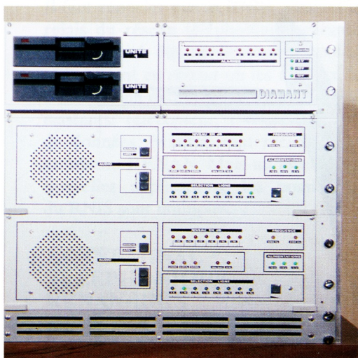
L'appareil DIAMANT: Dispositif Interactif d'Appels Multiples vers l'Annuaire et Télétel.
